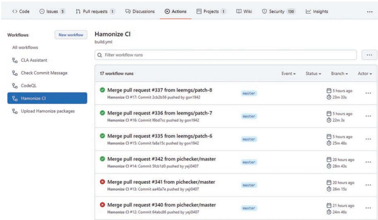
그림 18. Github Action을 이용한 지속적 통합 배포 환경의 구성 예
