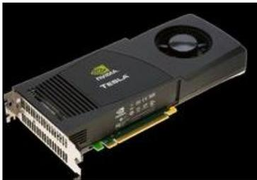
WS 서버 시스템의 PCI I/F 슬롯을 통해 장착되어 있는 NVidia CUDA(GPGPU) 지원 그래픽 카드들
